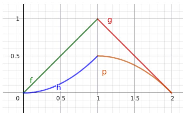
Figura 10: As curvas f e g descrevem a velocidade do carro e as curvas h e p descrevem a distância percorrida pelo carro.
